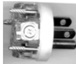
Passez le bout du câble par le capuchon. Le corps principal de la fiche a trois trous à l'arrière. Desserrez les vis près des trous. Celles-ci sont de couleurs différentes: argent, jaune et vert foncé. Le fil bleu doit aller dans le trou proche de la vis argentée, le fil brun près de la vis jaune, et le fil vert de mise à terre, *ainsi que le fil de drain*, près de la vis verte. *Attention de ne pas vous tromper!*
