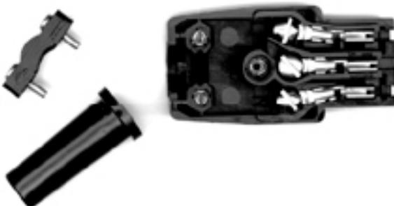
Le clamp et le tube que l'on voit à gauche, s'ils sont inclus, peuvent être jetés. Desserrez les trois vis de fixation, sans toutefois les enlever. La vis supérieure (selon notre photo) est pour le fil brun (sous tension, ou «live»), la vis du bas est pour le fil bleu (neutre), et la vis centrale est pour le fil vert (mise à terre). *Ces fils ne doivent absolument pas être interchangés!*
